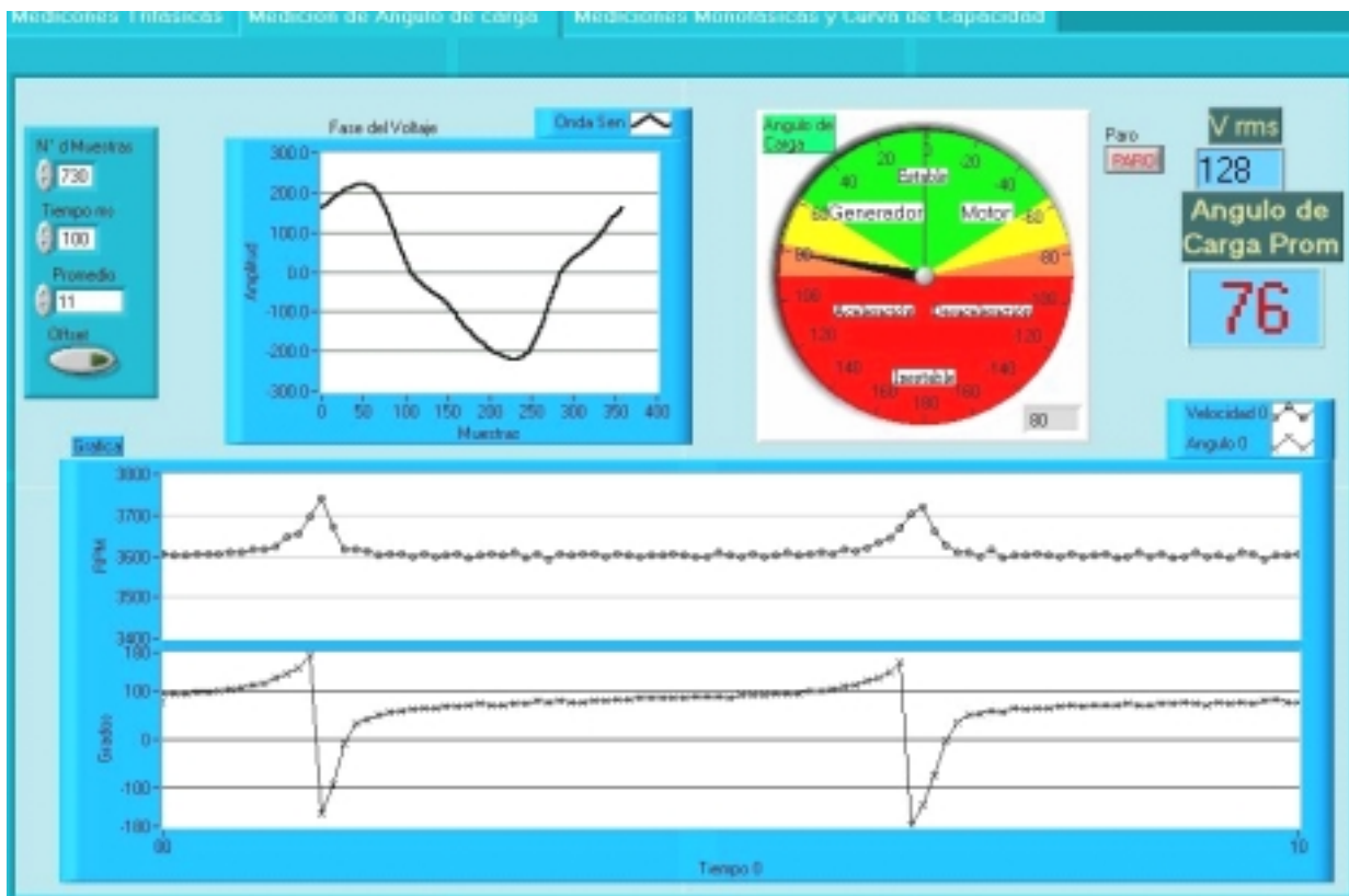
Figura 4.11 Medición del ángulo de carga Generador – Estado inestable
